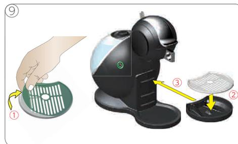
抽出グリッドのプラスチックフィルムを取り除き、抽出トレイに載せます。抽出トレイを抽出トレイ用フックに取り付け準備完了です。
