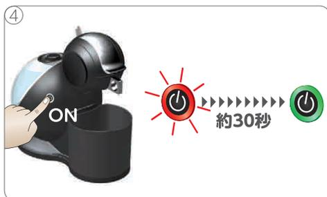
電源スイッチを押します。しばらくすると点滅が点灯に変わります。
