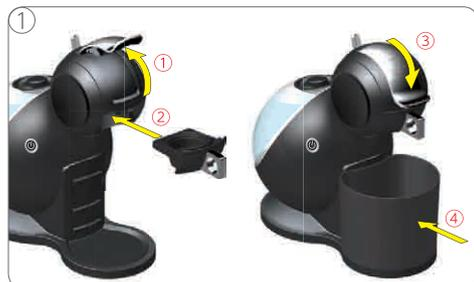
① ロックハンドルを上げて、カプセルホルダーを入れます。ロックハンドルを下げて、使用済みカプセル入れを置きます。
