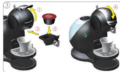
ロックハンドルを上げて、カプセルをカプセルホルダーに入れ、機器本体に挿入します。ロックハンドルを下げます。
