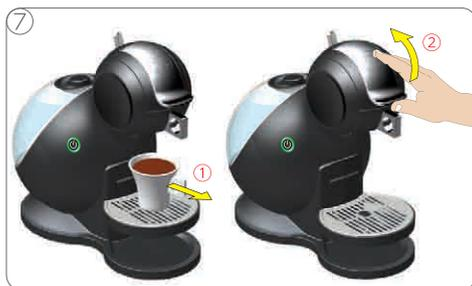
点滅が点灯に切り替わったら、ロックハンドルを上げてロックを解除します。
