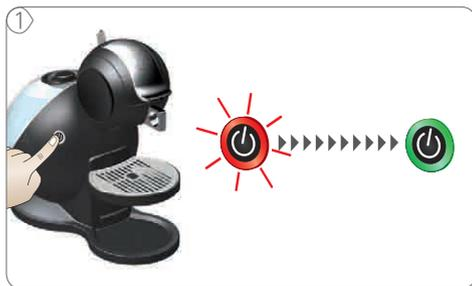
電源スイッチを押します。しばらくすると赤色点滅が緑色点灯に変わります。赤色点滅から緑色点灯に変わる時間は、使用状況により多少異なります。
