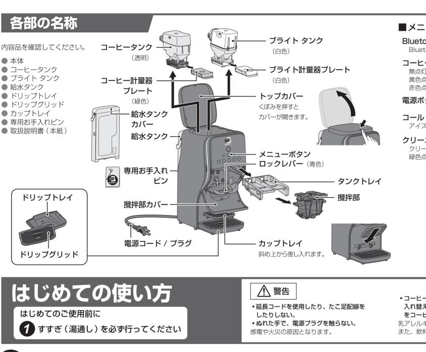
■メニューボタン 給水表示 給水が必要なときに点灯します。 Bluetooth表示 黄色点灯:給水タンクの飲用水が残りわずか Bluetooth機能がオンのときに青色点灯します。 赤色点灯:飲用水なし コーヒー残量表示・ 無点灯 : 残量十分あり 黄色点灯:残りわずか 赤色点灯:残量なし 電源ボタン -コールドメニューボタン・ アイスコーヒーを作るときに押します。 クリーニングボタン -クリーニングが必要なときに B (C) 緑色点滅します。 メニューボタン 本機の状態に合わせて抽出できるメニューが緑色点灯します。 メニュー
